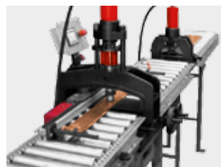
Возможность выполнения отверстий в не полном материале.
