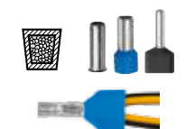
Форма опрессовки наконечника на проводе.
