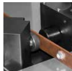
Вдавливание гаек SH 407.
