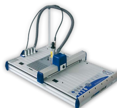
MK500-GRAVER Гравировальный набор для табличек, устанавливаемых на плоттеры MK500 или MK100 ▶ 102 ■ 151
