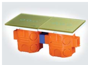
Osadzanie na puszkach łączników obok siebie Touchme, wymaga zastosowania większego rozstawu puszek. W puszkach szeregowych można go zwiększyć króćcem dystansowym KD12
