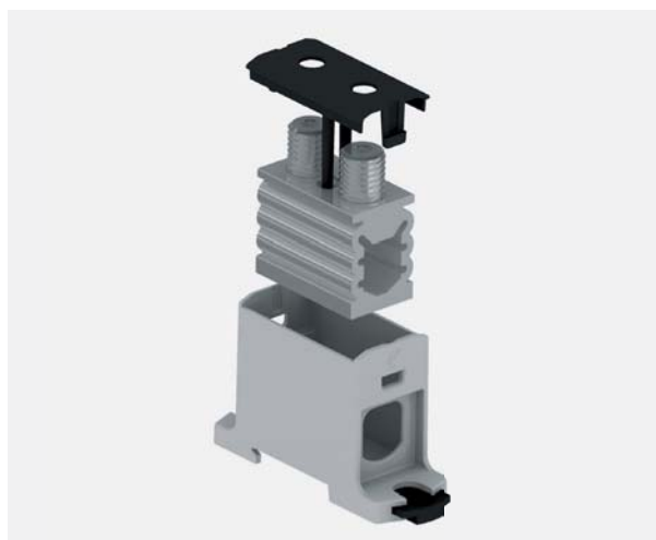
Złączka ma możliwość łatwego demontażu. Wystarczy nacisnąć odpowiednie zatrzaski. Daje to możliwość „nawleczenia” zacisku na część odizolowanego przewodu.
